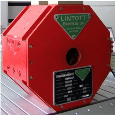
Abbildung 8: Vorderansicht des Quadrupols. Die Öffnung dient der Strahlführung [5]
