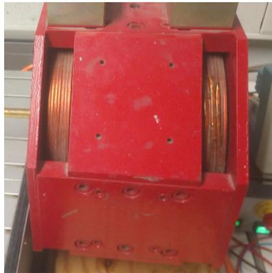
Abbildung 9: Seitenansicht des Quadrupols. Zu sehen sind die Spulen zur Erzeugung des Magnetfelds
