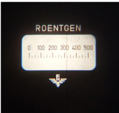
Abbildung 13: Anzeige eines Taschendosimeters in Einheit Röntgen ca. 320R. [13]
