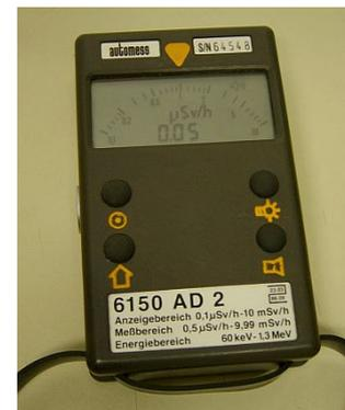
Abbildung 15: Dosisleistungsmessgerät wie es auch im Versuch Verwendung fand. Aktueller Ausschlag von  $0,05\mu\text{Sv/h}$ . [15]
