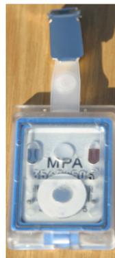
Abbildung 14: Vorderseite eines Filmdosimeters welches am Körper getragen wird. [14]
