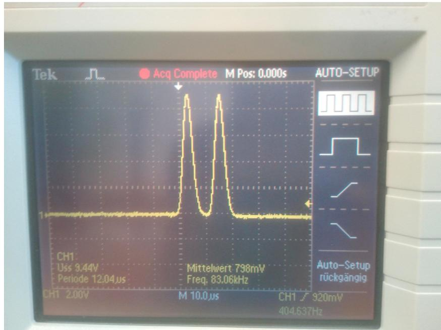
Abbildung 16: Signal nach dem Hauptverstärker (unipolar) mit zwei Signalen, die y-Skala in 2V Derivaten und die x-Achse in 10µs
