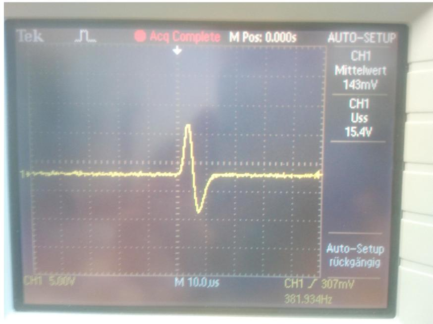
Abbildung 18: Signal nach dem Hauptverstärker (bipolar), die y-Skala in 5V Derivaten und die x-Achse in  $10\mu\text{s}$
