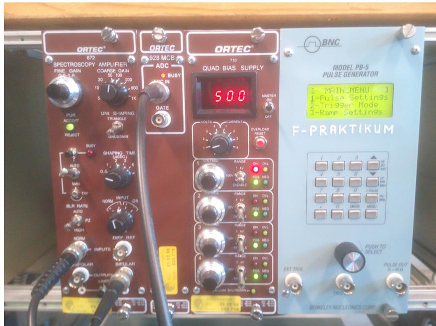
Abbildung 14: Hauptverstärker mit angeschlossenem Oszilloskop am unipolaren Ausgang
