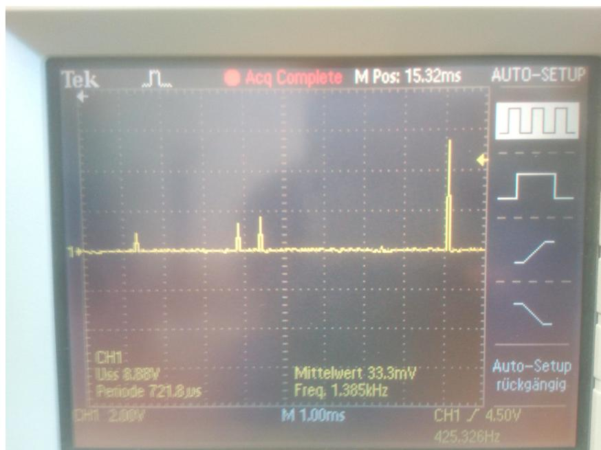
Abbildung 17: Signal nach dem Hauptverstärker (unipolar) mit mehreren Signalen unterschiedlicher Stärke, die y-Skala in 2V Derivaten und die x-Achse in 10µs
