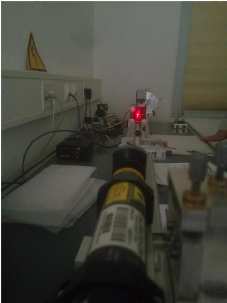
Abbildung 26: Ausrichtung der Spiegel mit Sicht entlang der optischen Achse. Von vorne nach hinten: Justagelaser, HR-Spiegel mit Reflektion des Justagelichts. Dahinter befand sich der Auskoppelspiegel, der auch zur Reflektion beitrug.
