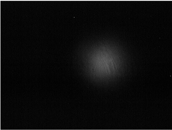
Abbildung 79: TEM<sub>00</sub>-Mode bei einer Resonatorlänge von 88cm
