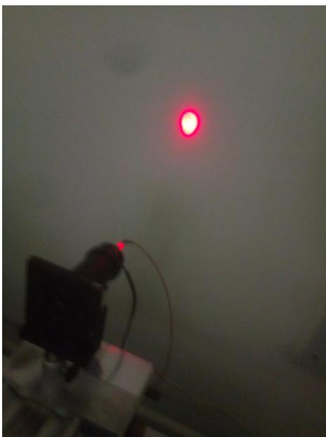
Abbildung 30: Ablenkung des Laserstrahls auf die hinter dem Interferometer liegende Wand. Dies geschieht durch die in Abbildung 28 und Abbildung 29 vorkommende und nun verwendete Linse.
