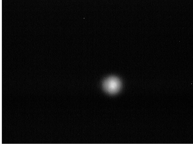
Abbildung 35: TEM<sub>00</sub> Mode bei einer Resonatorlänge von 25cm.
