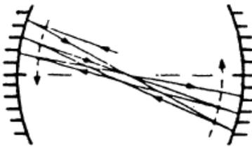
Abbildung 13: Fast konzentrischer Resonator mit  $\frac{L}{2} < R_1, R_2 < L$  und somit  $g_1 = g_2 \approx -1$
