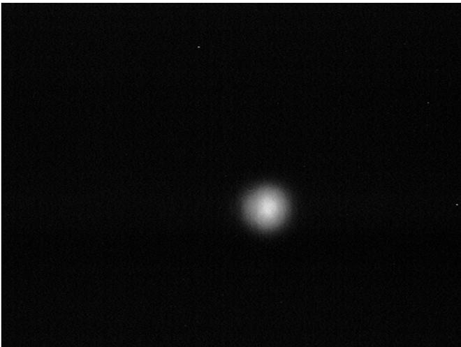
Abbildung 47: TEM<sub>00</sub>-Mode bei einer Resonatorlänge von 25cm
